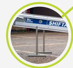
**Tréteau** pour assurer la stabilité du convoyeur et ajuster son angle d'inclinaison.
